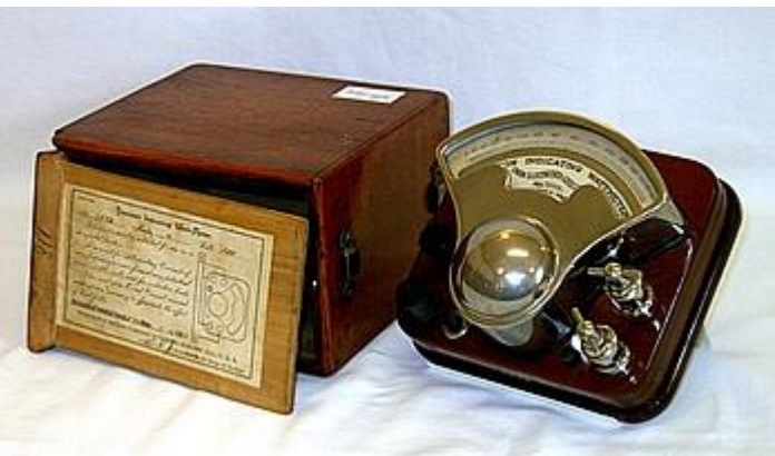
Spiegel-Leistungsmessgerät aus dem Jahre 1898
