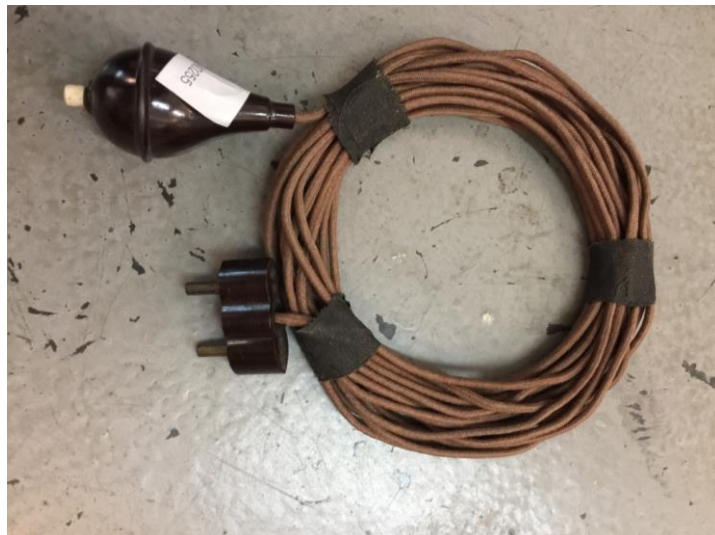
Bild 5: Birnenförmiger Klingelknopf mit Schnur für eine Dienstbotenklingle
