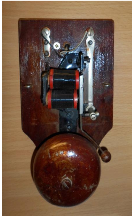
Bild 4: Geöffnete Klingel mit einem Wagnerschen Hammer
