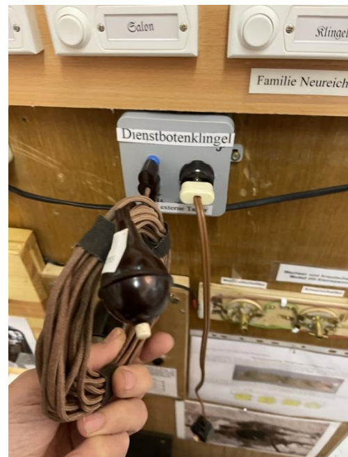
Bild 7: links Kasten mit zwei unterschiedlichen Anschluss-Buchsen, rechts mit zwei eingesteckten mobilen Klingelknöpfen
